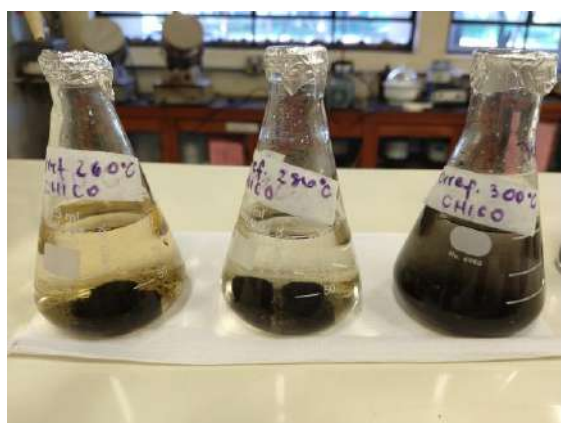
Fig. 5. Estabilidade em meio aquoso dos péletes de torrefação a 260^{\circ}\text{C} , 280^{\circ}\text{C} e 300^{\circ}\text{C} .
