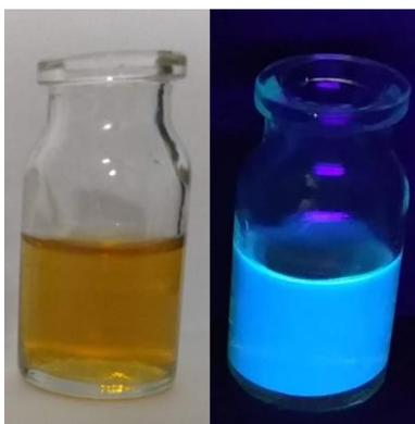
Fig. 1: Dispersão aquosa da amostra PCCELN sob iluminação natural (à esquerda) e exposta a radiação ultravioleta, 365 nm (à direita).
