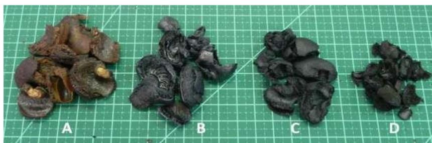
Fig. 2. (A) CCC; (B) pré-carbonizada; (C) Carbonizada; (D) Ativada.
