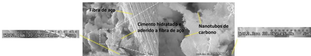
Fig. 1. Imagens de compósito cimentício com uso de fibras de aço e nanotubos de carbono, obtidas por meio de microscopia eletrônica de varredura (adaptada de [5])
